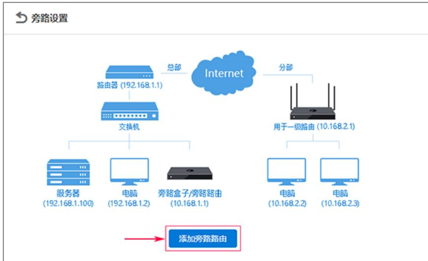
旁路可通过 IP 网络段和 IP 地址两种进行设置
